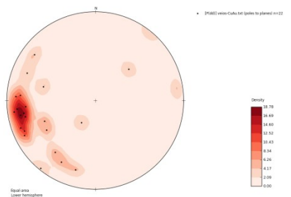
Figura 21: Estruturas com sulfetos de Cu e Au (BRSMMD0235)
