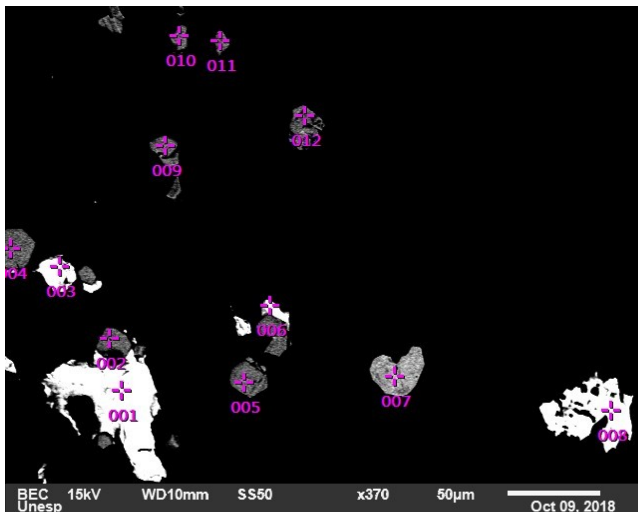
Figura 23: Imagem de varredura de sulfetos na amostra 094-2. Os pontos analisados são apresentados no Quadro 1.
